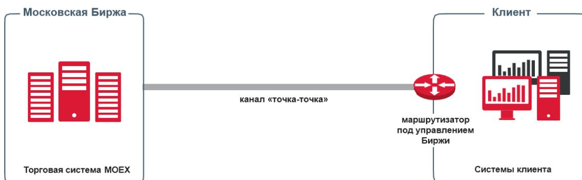
ConnectME — это один из способов организации сетевого доступа к сервисам Московской Биржи. Данная схема подключения включает в себя каналы связи точка-точка, реализованные операторами связи по выбору клиента, оборудование клиента под управлением Биржи и сетевые сегменты для размещения торговых систем клиента, организованные согласно требованиям Биржи. Более подробная техническая информация предоставлена в разделе [«Техническая схема»](#).
